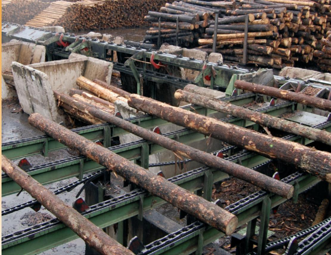
**Splitterholz mit Metallteilchen wird vollautomatisch aus der laufenden Produktion aussortiert und computergesteuert in die richtige Box ausgeworfen.**
