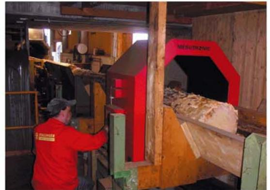
Der Metalldetektor METRON<sup>®</sup> CO von MESUTRONIC<sup>®</sup> mit Farbmarkiereinrichtung spürt bei Stallinger Timber Industrie im oberösterreichischen Frankenmarkt in großen Baumstämmen Metallsplitter und Nagel zuverlässig und betriebssicher auf.
