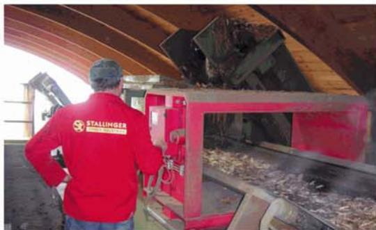
Der Metalldetektor METRON D schützt bei Stallinger die Mühle vor Schäden durch Metallteilchen.
